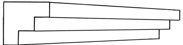
CP155 Projection 108mm(4 1 / 4 "") Depth 108mm(4 1 / 4 "")
