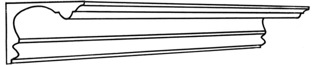
CP163 Projection 140mm(5 1 / 2 "") Depth 110mm(4 3 / 8 "")
